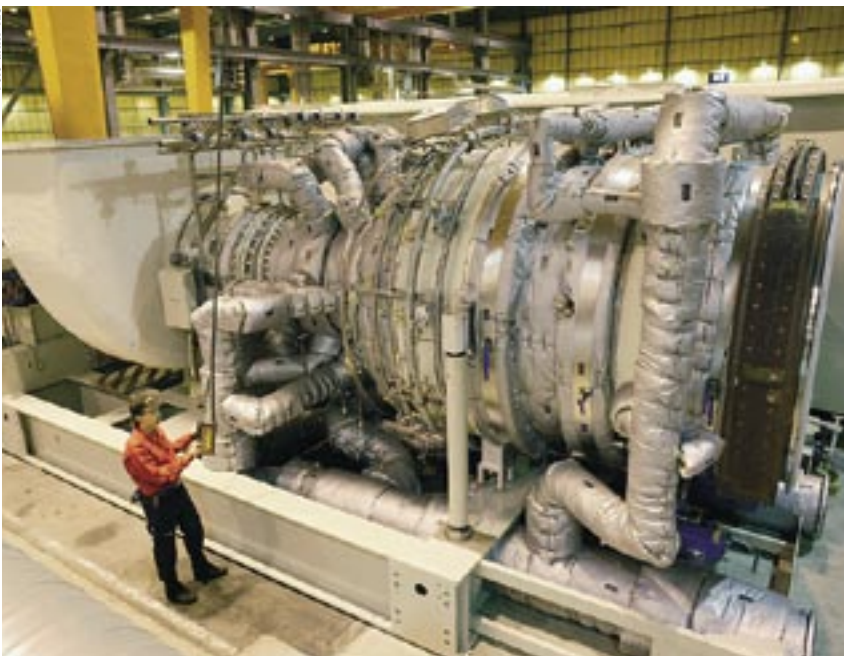
Plinska turbina SGT800 proizvajalca Siemens.
