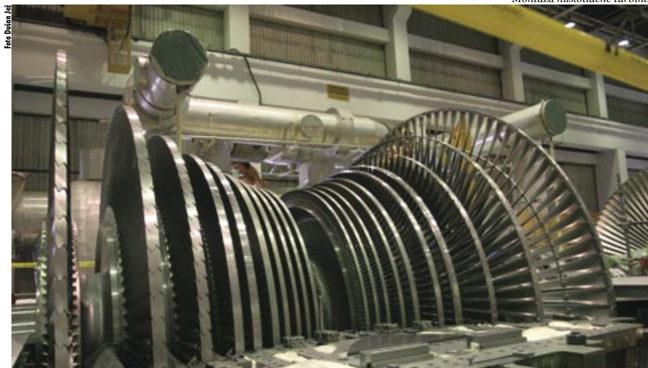
Montaža nizkotlačne turbine.
