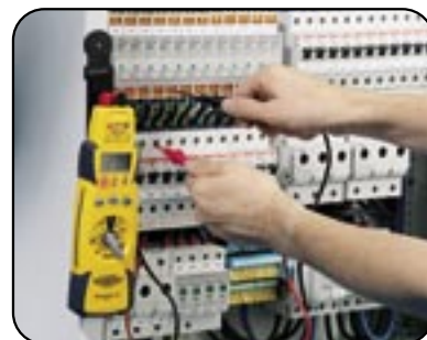
testerji za napetost in magnetno polje
