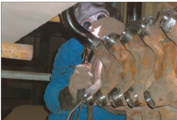
Varjenje mešalnega kolektorja.
