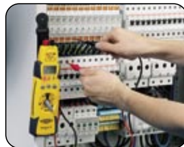
testerji za napetost in magnetno polje
