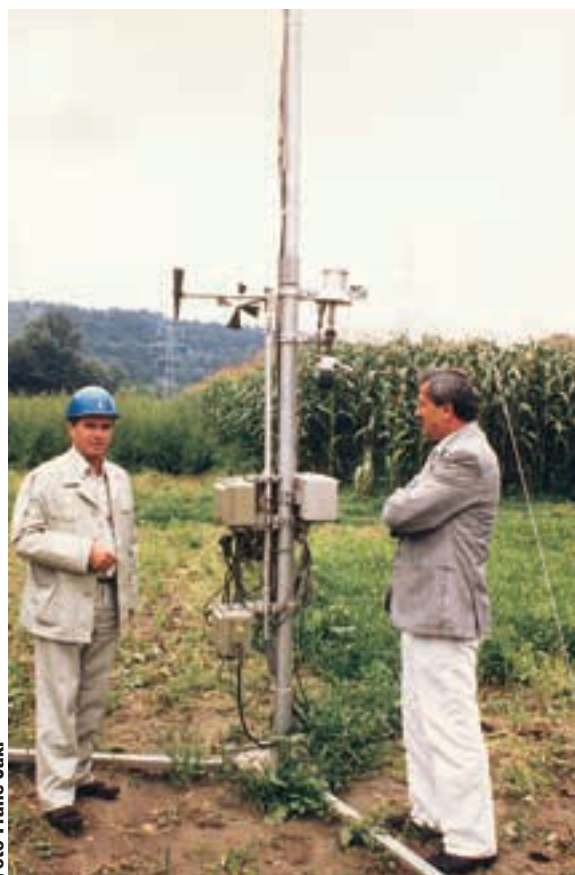
Terenska meteorološka postaja, vgrajena v stikališčnem platoju RTP za potrebe monitoringa termične obremenljivosti prenosnega sistema Eles.
